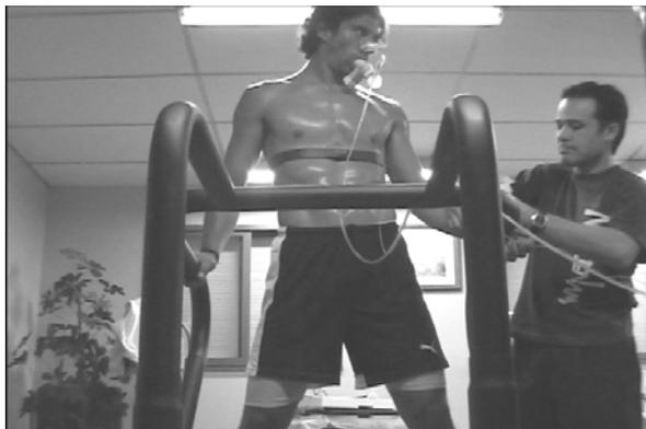
Figura 3 – Ajuste Dispositivos del Analizador Fijo MedGraphics BREEZE Ex
